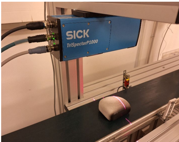
Slika 2: Postavitev laserskega skenerja nad tekočim trakom
