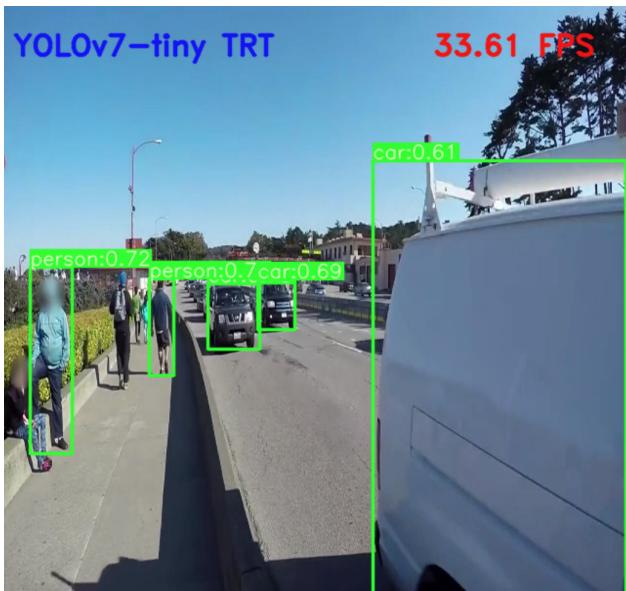
Slika 3: Rezultat aplikacije z YOLOv7 Tiny in TensorRT.
