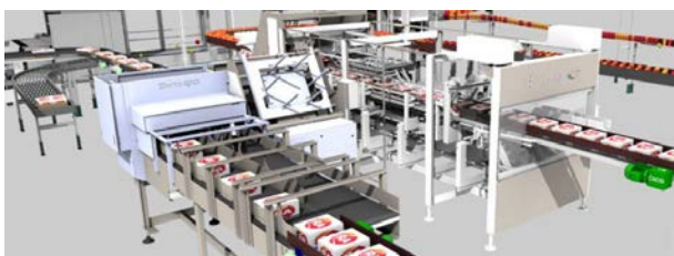
Slika 8: Primer uporabe virtualnega dvojčka v fazi virtualnega zagona
