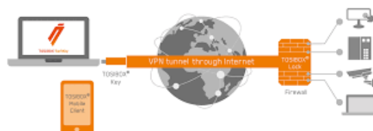
Slika 6: S kriptirnim ključem na strani računalnika dostopamo do naprav, ki so povezane s Tosibox Lock napravo. VPN povezava se vzpostavi samodejno.
