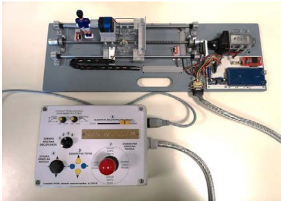
Slika 7: Del avtomatiziranega sistema namiznega nogometa (Aleksander Breznik).
