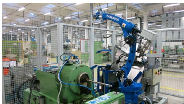
Slika 8: Robotska celica za strego.
