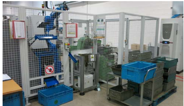
Slika 5: Vhodne in izhodne enote robotske celice za izdelek.
