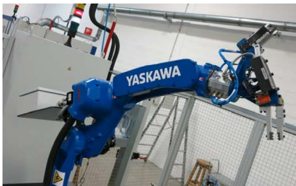
Slika 7: Robot GP12 z robotskim prijemalom in poveznim paketom speljanim skozi votle robotske osi.
