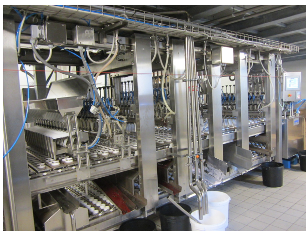
Slika 6: Stroj za oblikovanje sladoleda.
