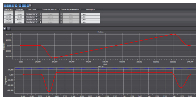
Slika 7: CAM profil šobe za oblikovanje sladoleda.
