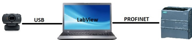
Slika 9: Povezava: spletna kamera - računalnik – PLK.
