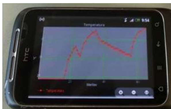
Slika 7: Dvigovanje temperature ob dotiku senzorja.
