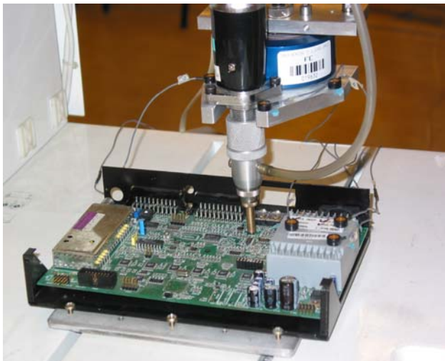
Slika 2: Merilnik sil ter merilni markerji za zajemanje sil in gibanja med vijačenjem elektronskega vezja v ohišje
