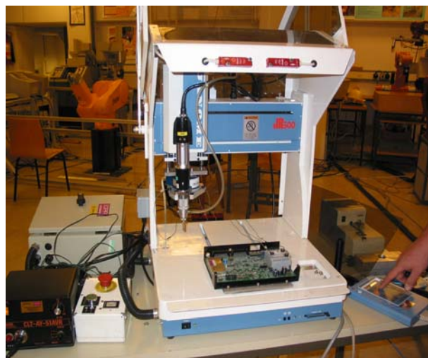
Slika 1: Sistem za avtomatsko vijačenje elektronskih vezij v ohišja
