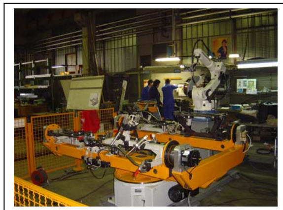
Slika 10: Vpenjalne priprave na H-mizi ter v ozadju robot AX-V6
