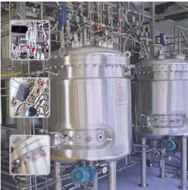
Slika 1: primer posode iz nerjavečega jekla primerne za farmacijsko industrijo
