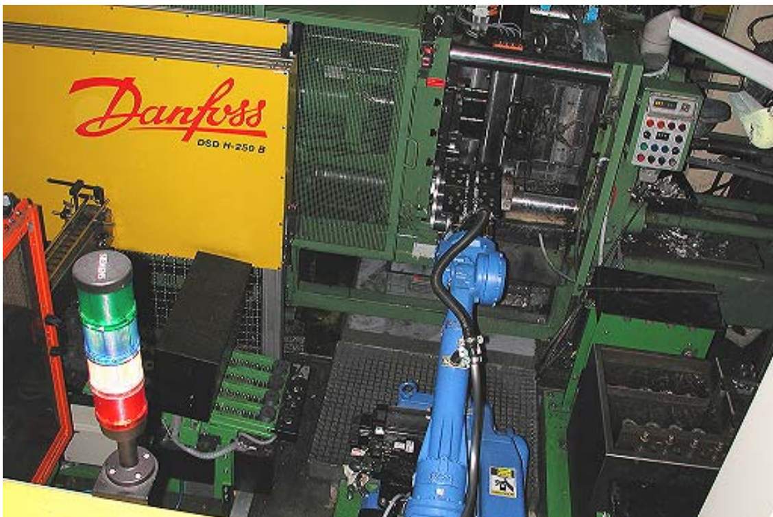
Slika 4: Robotska strega stroja za tlačno litje aluminija
