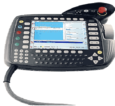
Slika 3: KCP – Kuka Control Panel (uporabniški vmesnik)
