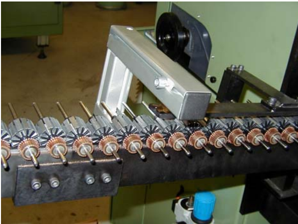
Slika 4: Proizvodna rotorjev malih gospodinjskih aparatov v BSH Nazarje in uporaba končne vizualne kontrole
