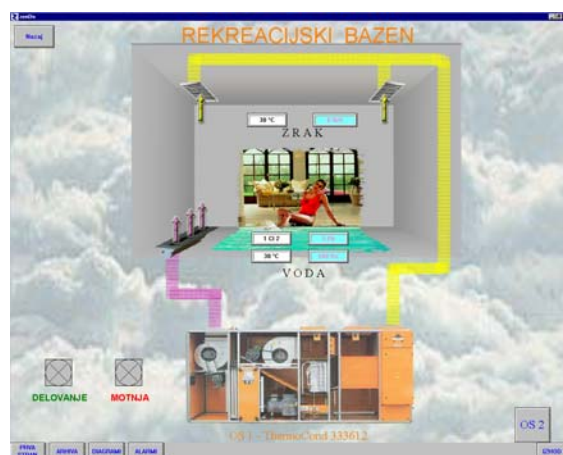
Slika 4: Nadzorni sistem – klimat za klimatizacijo bazenskega prostora rekreacijskega bazena
