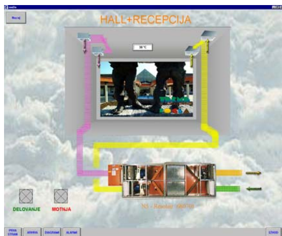
Slika 3: Nadzorni sistem – klimat za prezračevanje in hlajenje vhodnega hall-a z recepcijo
