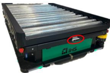
Slika 3: Montaža kamere na zunanjo stran AMR-ja.
