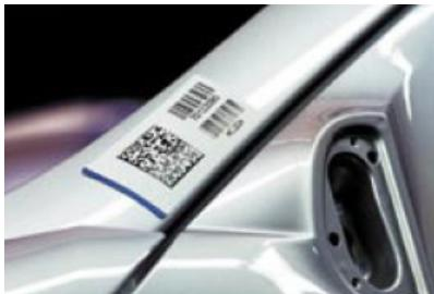
Slika 3: V Daimler Chrysler tovarni se matrična koda uporablja za končno in posamično sestavo avtomobila. Uporaba te kode je dosti enostavnejša in cenejša od RFID kode, distanca branja pa lahko seže do 2m. Ustreza normativom TS16949 za sledljivost v avtomobilski industriji.
