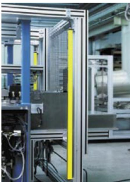
Slika 5: Tovarna Delphi (Francija) proizvode več kot 2 milj. klimatskih naprav letno. Zaradi preproste vgradnje in kompaktnih dimenzij so se odločili za uporabo F3SN varnostnih zaves.
