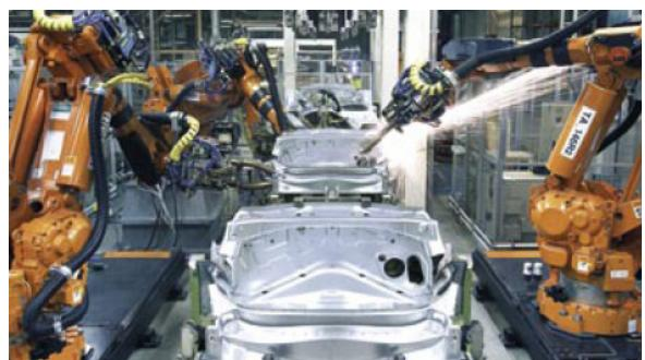
Slika 6: V Valmet avtomobilski tovarni (Finska) je bilo do danes izdelanih preko milijon avtomobilov in od leta 1997 več kot 100.000 Porche Boxter. Šasija, barvanje, in končna montaža so izvedeni z Omron PLC sistemom, povezanim preko Ethernet, Controller Link ali Device Net komunikacije. Poleg tega Valmet uporablja Omron senzoriko, frekvenčne pretvornike, RFID in sisteme za vizualno kontrolo.
