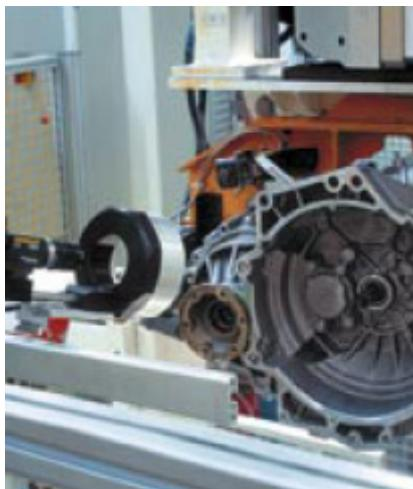
Slika 1: V VW tovarni v Baunatalu se izdela približno 12.000 menjalnikov za VW in audi dnevno. Vision sistem F150 preverja, da ni zaščitnih prevlek na ojnicu. Zaradi različnih barv in maziva je uporabljen IR osvetlitev, ki zagotavlja konsistentne pogoje za meritev.
