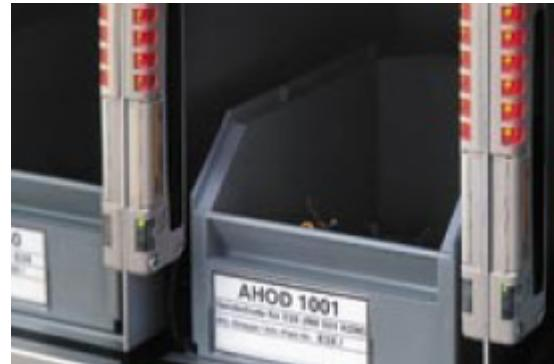
Slika 4: Zanesljiva montaža z osvetljeno kontrolo t.i. picking senzorja, ki preprečuje napake pri montaži zaradi zmedenosti, menjave delovnega mesta ali neustreznega učenja delavca.
