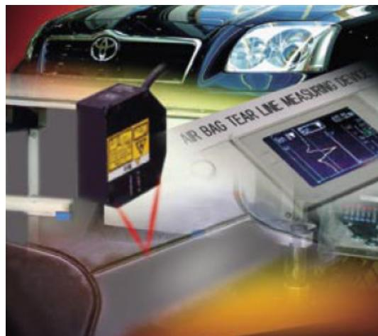
Slika 2: Tovarna Toyota (UK) uporablja Z500 laserski profilni senzor za natančno meritev globine razporka zračne varnostne blazine na Avensis modelu. Proses kontrole je zelo kritičen, saj mora zagotavljati popolnost in 100% delovanje v primeru trka. Vsi rezultati se shranjujejo. Z500 sistem omogoča meritev z natančnostjo  $0,25\mu\text{m}$ .
