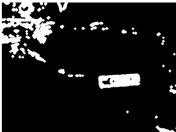
Slika 7: Dilatiran segment bele barve
