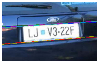
Slika 8: Prikazane linije, s pomočjo katerih algoritem določi kot zasuka
