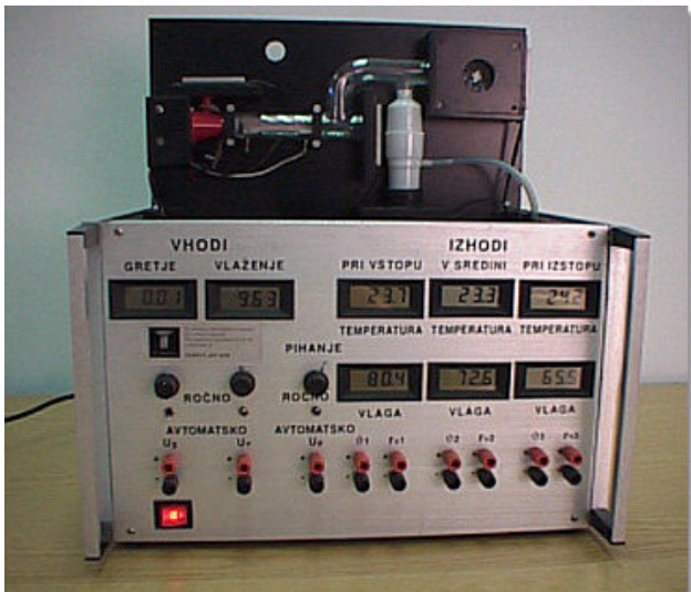
Slika 3: Klimatska naprava s kontrolno ploščo
