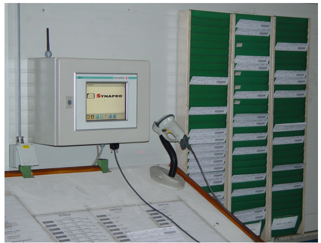
Slika 1: Primer terminala za ročni vnos dogodkov iz proizvodnje
